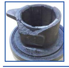
Tubo guia da caixa de engrenagens desgastado / marcas de desgaste / picado sobre o rolamento (diâmetro interno - interior do rolamento)
