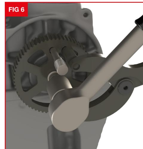
Une fois que le boulon de réaction B est en butée dans l'arbre à cames, retirez-le et terminez le montage à l'aide du boulon de fixation d'origine.
