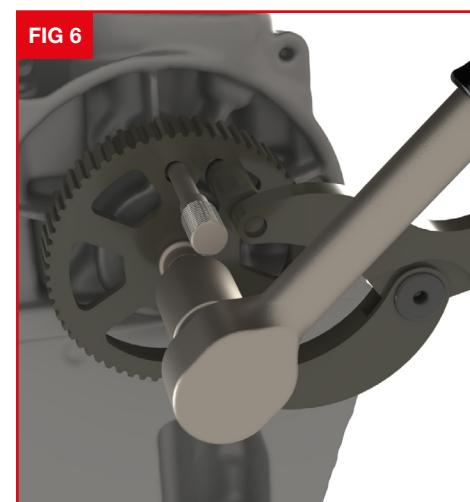
Как только реактивный болт В достигнет нижней точки на распределительном валу, снимите его и завершите установку с помощью оригинального крепежного
