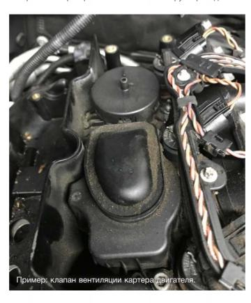
Эти неисправности вызывают повышенный расход масла, горение масла, потерю мощности двигателя, пропуски зажигания и возникновение больших отложений сажи. Ранние признаки неисправности системы вентиляции картера: свистящий шум в системе впуска, голубоватый дым из выхлопной трубы, повышенный расход масла и толстый слой осадка белого или желтого цвета на внутренней стороне пробки маслозаливного отверстия.
