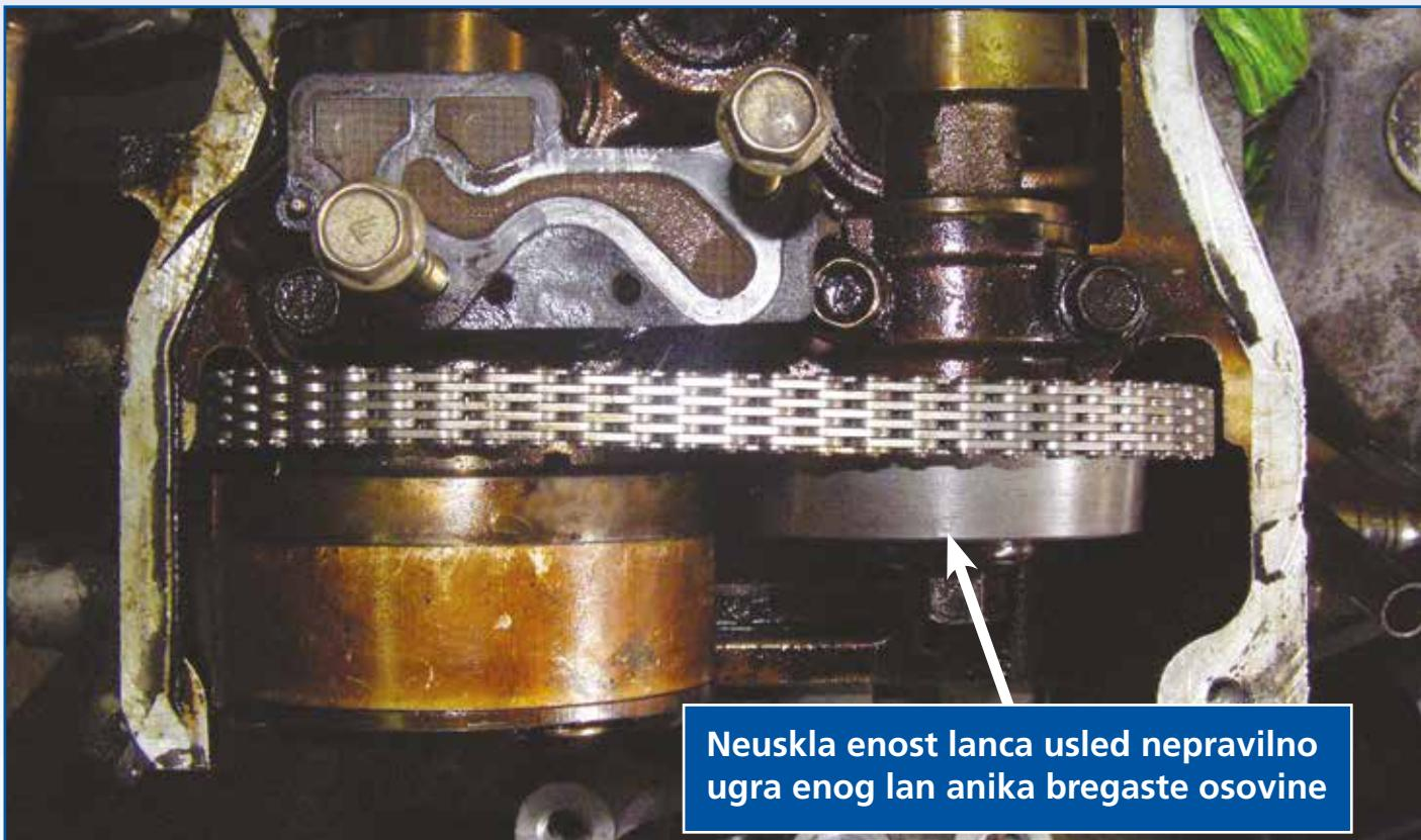
Neuskla enost lanca usled nepravilno ugra enog lan anika bregaste osovine
