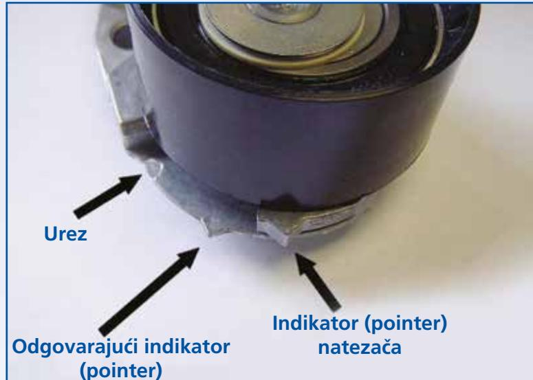
**Nemojte unositi ni u jednom trenutku nikakav alat u sklop natezača ni za držanje ni za podešavanje remenice natezača. Ukoliko bi to uradili moglo bi doći do prernog defekta sklopa natezača i sve takve reklamacije u jamstvu će biti odbačene.**
