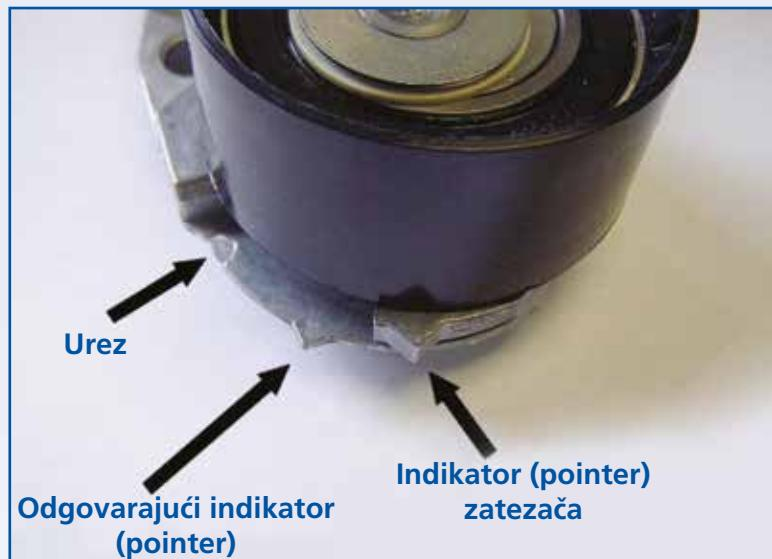
**Nemojte da unosite ni u jednom trenutku nikakav alat u sklop zatezača ni za držanje ni za podešavanje remenice zatezača. Ukoliko biste to uradili moglo bi doći do preranog defekta sklopa zatezača i sve takve reklamacije u garanciji će biti odbačene.**
