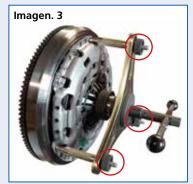
• Gire el asa de la herramienta de compresión en el sentido de las agujas del reloj sobre el diafragma de la maza de embrague y comprima las lengüetas hasta que la carcasa de la maza de embrague haga contacto con el volante motor. (Imagen 4)
