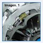
Los embragues autoajustables se identifican mediante el mecanismo autoajustable visible en la maza de embrague. (Imagen 1)
