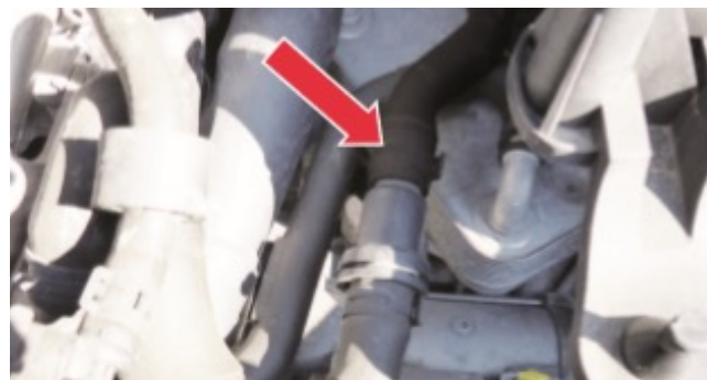
Abb. 1: Das Thermostat ist in den flexiblen Schlauch am Wärmetauscher (unter dem Luftfiltergehäuse) integriert.
