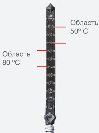
После замера уровня масла выньте щуп из направляющей! Установите заглушку с новым фиксатором febi 44204 в направляющую щупа.
