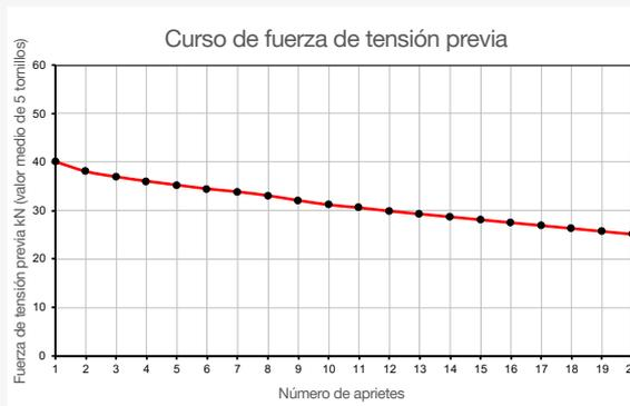
que el tornillo está demasiado apretado. Esto provoca una prolongación de la sujeción hasta la deformación plástica (ver figura 3).
