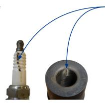
El ejemplo B muestra dónde ha habido fuga de la chispa a lo largo de la cerámica de la bujía de encendido (ver marcas de quemado).
