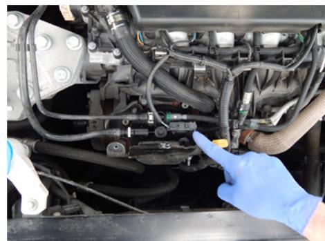
Conector do sensor de temperatura do combustível
