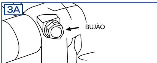
O pino de 8 mm destina-se a ser utilizado em veículos equipados com um veio de equilíbrio, para bloquear o veio. Nota: não aplicável a todos os modelos. Para efetuar este procedimento, remova o bujão do lado frontal esquerdo do bloco do motor e insira totalmente o pino, como se mostra acima.
