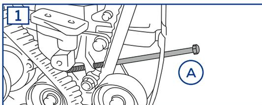
O longo parafuso de tensão é utilizado para aplicar pressão suficiente no tensor automático, de forma a permitir a remoção do pino de fixação do pistão do tensor, sem correr o risco de danificar nenhum carreto de distribuição.
