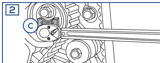
O adaptador do tensor permite, segundo as instruções do fabricante, a aplicação de um binário que pode variar entre 2 e 5 Nm, dependendo do modelo. Dois pinos no adaptador são alinhados com dois orifícios no tensor, e um orifício quadrado de ¼" no adaptador permite utilizar uma chave dinamométrica para binários inferiores (ADG05515).
