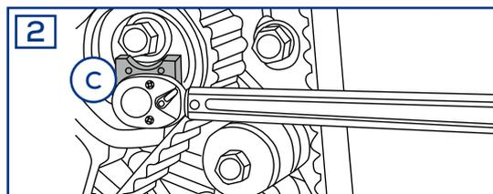
Adapter ležaja zatezača omogućava primenu obrtnog momenta u skladu sa uputstvima proizvođača koji može da varira između 2 i 5 Nm zavisno od modela. Dva osigurača na adapteru podešavaju se prema dva otvora na ležaju zatezača, a kvadratni otvor na adapteru omogućava korišćenje moment ključa malog obrtnog momenta (ADG05515).
