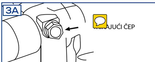
8mm osigurač se koristi na vozilima opremljenim sa uravnotežavajućim vratilom za blokiranje vratila. Važno: nije primenljivo na svim modelima. Ovo se radi skidanjem čepa iz prednje leve strane bloka motora i ubacivanjem osigurača do kraja, primenljivo kao što je prethodno prikazano.
