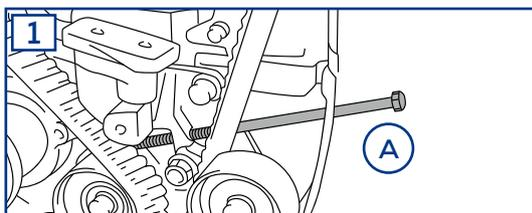
Dugački vijak zatezač koristi se za primenu dovoljnog pritiska na automatski zatezač kako bi se omogućilo skidanje potpornog osigurača hidrauličkog klipa zatezača bez rizika od oštećivanja delova sistema zupčanika razvoda.
