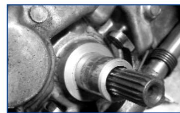
Desgaste del tubo guía de la transmisión.
