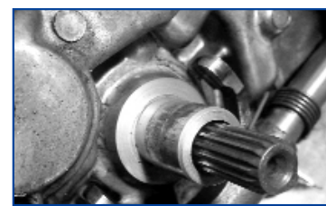
Usura della guida tubolare della trasmissione
