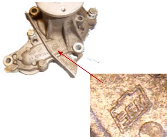
Die original SEM-Pumpe kann anhand des Herstellerzeichens am äußeren Gehäuse identifiziert werden (siehe Abbildung).
