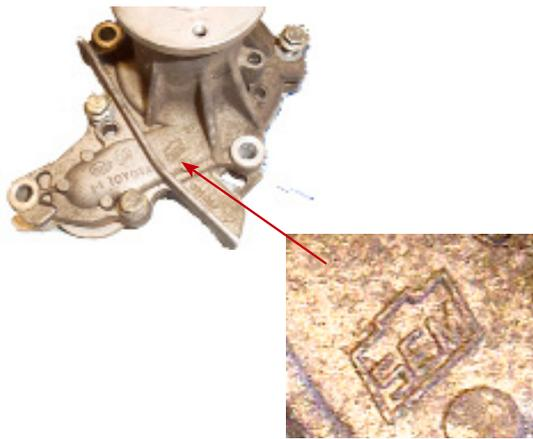
**La pompe de type SEM d'origine** peut être identifiée par la marque du fabricant sur le boîtier externe (voir l'image)
