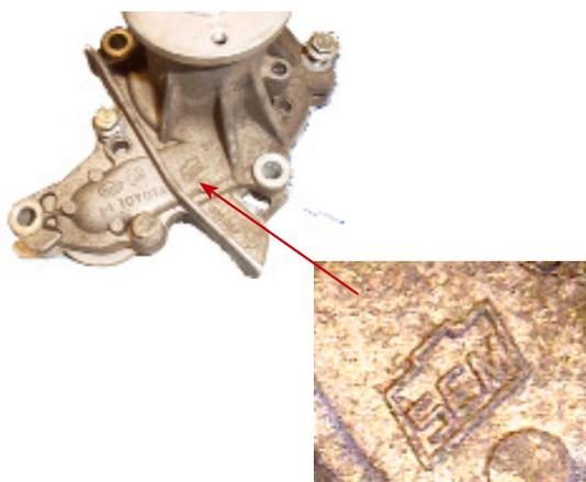
**La pompa originale del tipo SEM** è identificabile tramite il marchio del produttore sulla parte esterna; vedere la figura.
