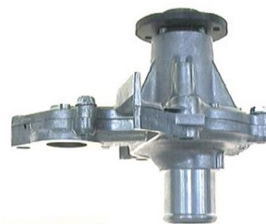
Perfil lateral da bomba de substituição tipo SEM, com as estruturas frontal e posterior previamente montadas.
