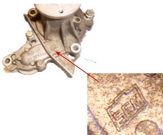
**A bomba original tipo SEM** pode ser identificada pela marca do fabricante na estrutura exterior (veja a imagem)
